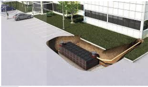
פרט עקרוני לתפיסת מי מרזבים וחלחולם לתת הקרקע – נפח נגר גדול (למשל, מבני ציבור).
